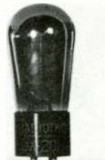
RADIOTRON UX 201A DET. AMP. 5 VOLTS
