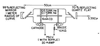
Fig. 1-Laser gas detector.
