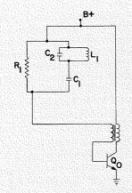
Fig. 16—Base-voltage waveshaping technique.
