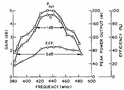
Fig. 4—200-watt amplifier performance.
