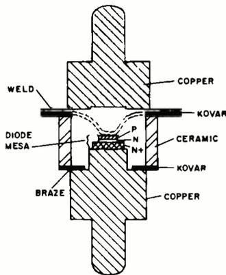
Fig. 2—Avalanche diode package.
