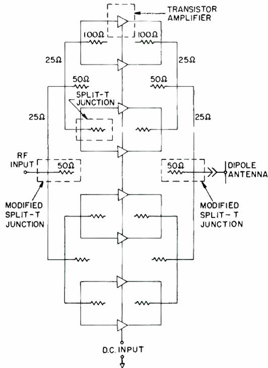
Fig. 1—200-watt amplifier schematic.
