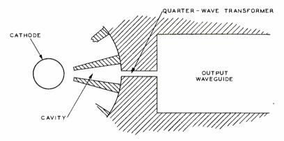
Fig. 1-Waveguide-output magnetron.
