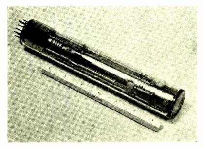
Fig. 2-The Mimo tube.
