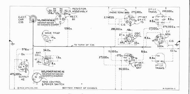
Figure 5—Resistance Diagram
