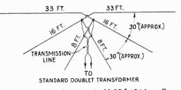
(d) Triple Doublet Antenna for 40, 20& 10 Meter Bands Figure 4—Dipole Antenna Crossover Connections.
