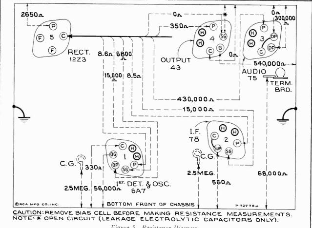
Figure 5—Resistance Diagram
