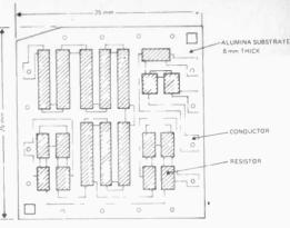
Fig. 2. Thick-film resistor layout.
