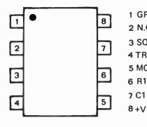
1 GROUND 2 N.C. 3 SQUARE WAVE OUTPUT 4 TRIANGLE WAVE OUTPUT 5 MODULATION INPUT 6 R1 7 C1
