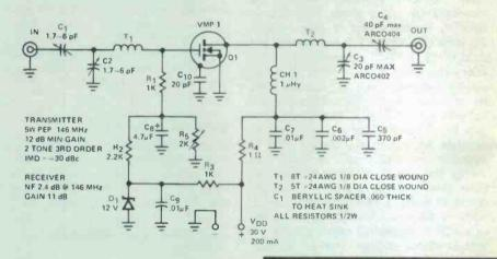
Fig. 17 144-146 MHz linear amplifier (Siliconix).
