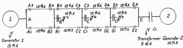
FIG. 5—SYSTEM LAYOUT FOR ILLUSTRATING CURRENT DISTRIBUTION
