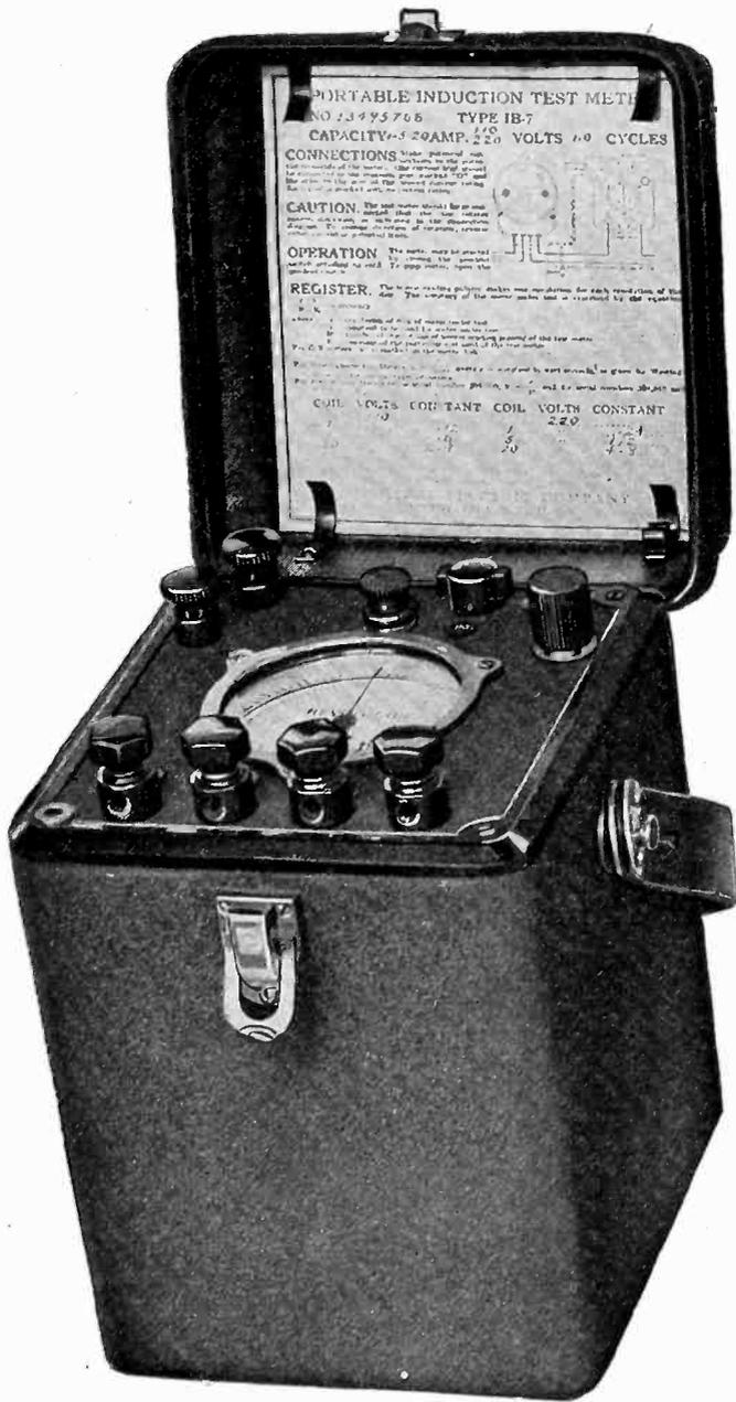
Type IB-7 Portable Test Meter
