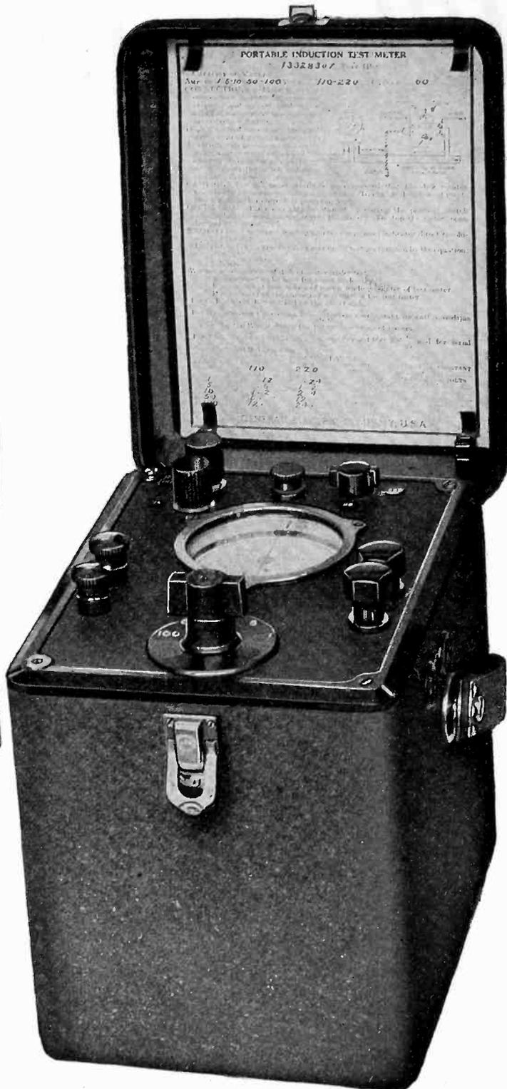
Type IB-8 Portable Test Meter
