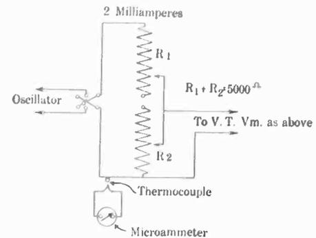
FIG. 5—CALIBRATION CIRCUIT
