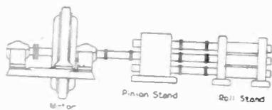
FIG. 1—ROLLING MILL, SINGLE STAND
