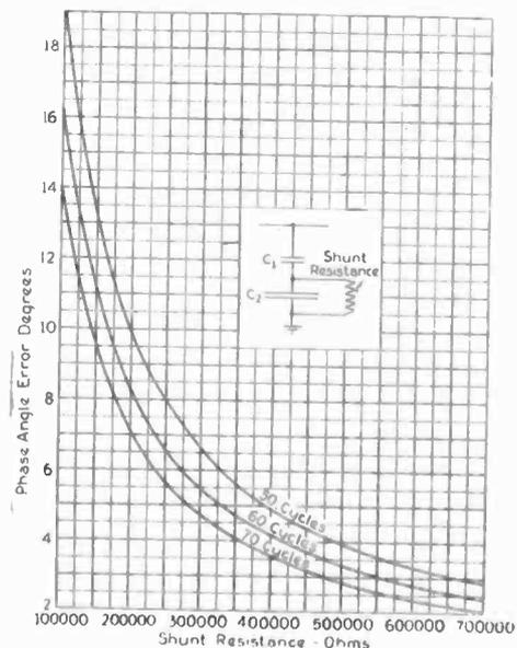
FIG. 10—PHASE-ANGLE CHARACTERISTICS OF CAPACITANCE TRANSFORMERS
