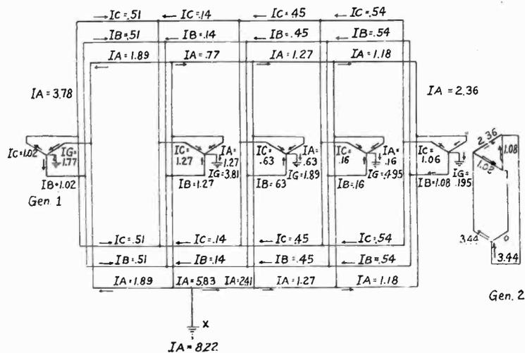
FIG. 6—FAULT-CURRENT DISTRIBUTION DIAGRAM
