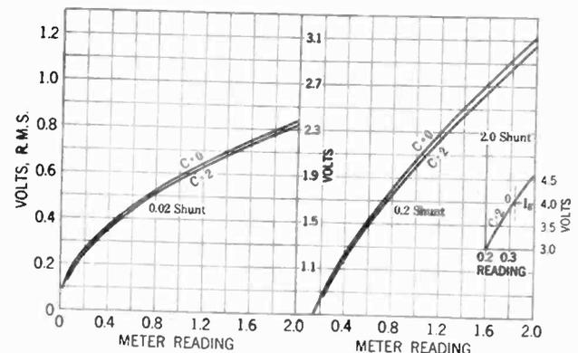
FIG. 6—SAMPLE CALIBRATION VACUUM TUBE VOLTMETER
