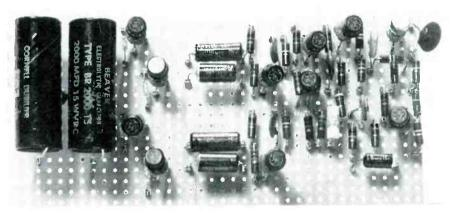
Fig. 22. Schmidt-trigger modulator amplifier.
