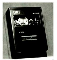
AIWA'S DAT-2000 PROTOTYPE MINIATURE RDAT RECORDER ILLUSTRATES THE SIZE TO WHICH RDAT MACHINES MAY ULTIMATELY BE REDUCED. THE ROUND HEAD DRUM IS ONLY 30 MILLIMETERS ACROSS.
