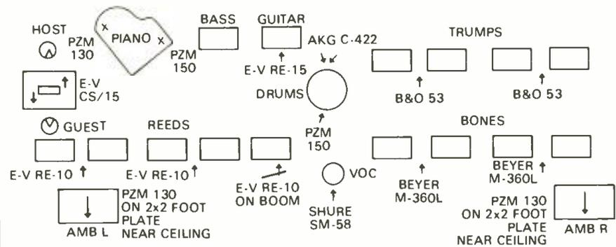
Figure 9: TYPICAL BIG BAND SETUP FOR LIVE REMOTE
