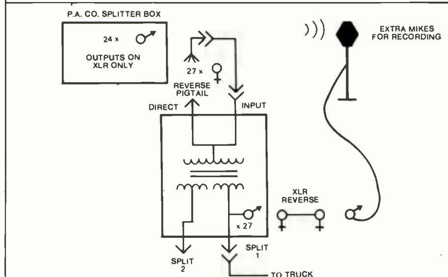
3 SETUP SHOWING USE OF EXTRA XLR CONNECTORS ON RECORD PLANT SPLITTER BOX.
