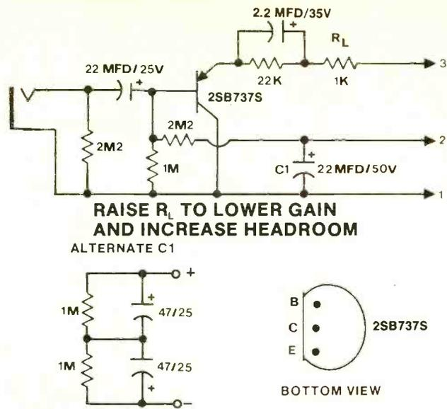
FIG. 8: PHANTOM POWERED ACTIVE DIRECT BOX
