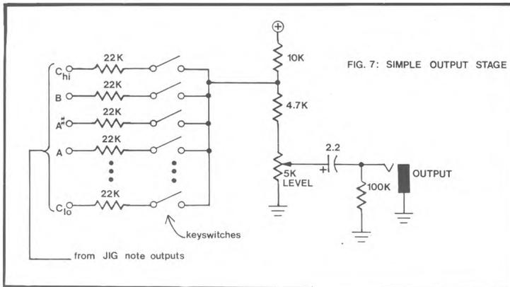
FIG. 7: SIMPLE OUTPUT STAGE
