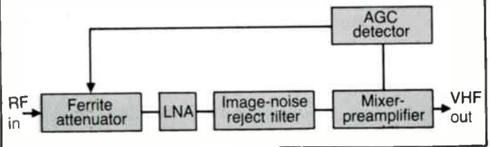
**Figure 4:** External LNA arrangement
