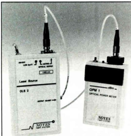
**FIBER OPTIC TESTING FOR CATV**
