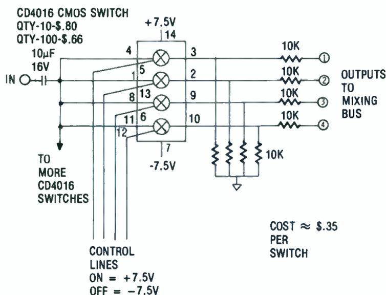
Figure 2. CMOS IC switch module.
