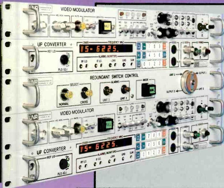
TYPICAL REDUNDANT CONFIGURATION
