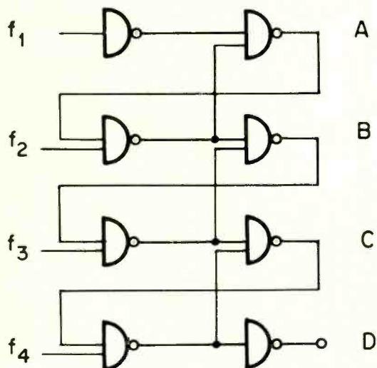
$$\begin{aligned} f_1 + A \cdot f_2 &= A \\ f_2 \cdot A + B \cdot f_3 &= B \\ f_3 \cdot B + C \cdot f_4 &= C \\ f_4 \cdot C &= D \end{aligned}$$
