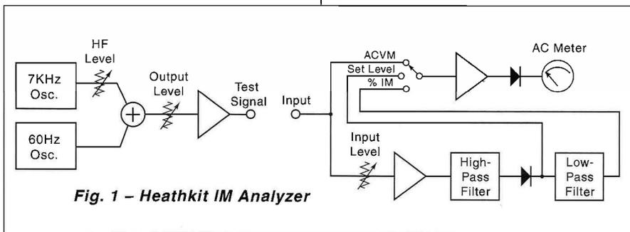
Fig. 1 – Heathkit IM Analyzer
