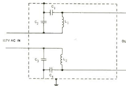
$C_1 C_2 C_3 C_4$  500 pF mica.
