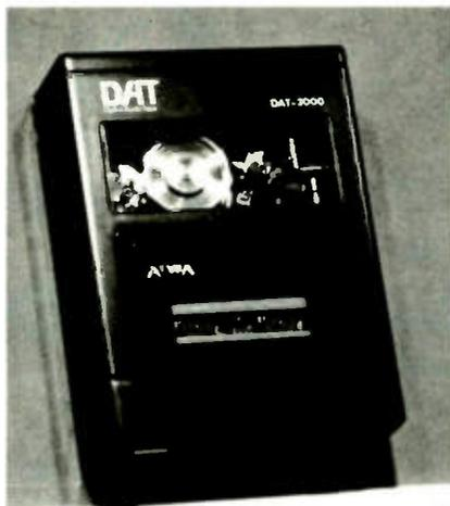
AIWA'S DAT-2000 PROTOTYPE MINIATURE R-DAT RECORDER ILLUSTRATES THE SIZE TO WHICH R-DAT MACHINES MAY ULTIMATELY BE REDUCED. THE ROUND HEAD DRUM IS ONLY 30 MILLIMETERS ACROSS.
