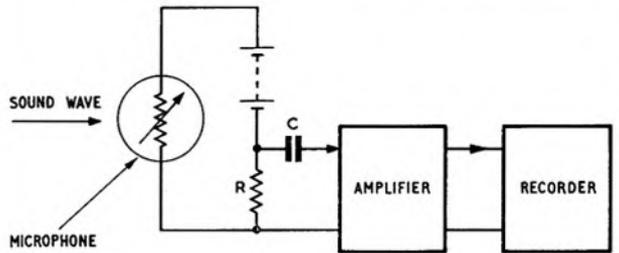
FIG. 2 TAPE RECORDER SCHEMATICS
