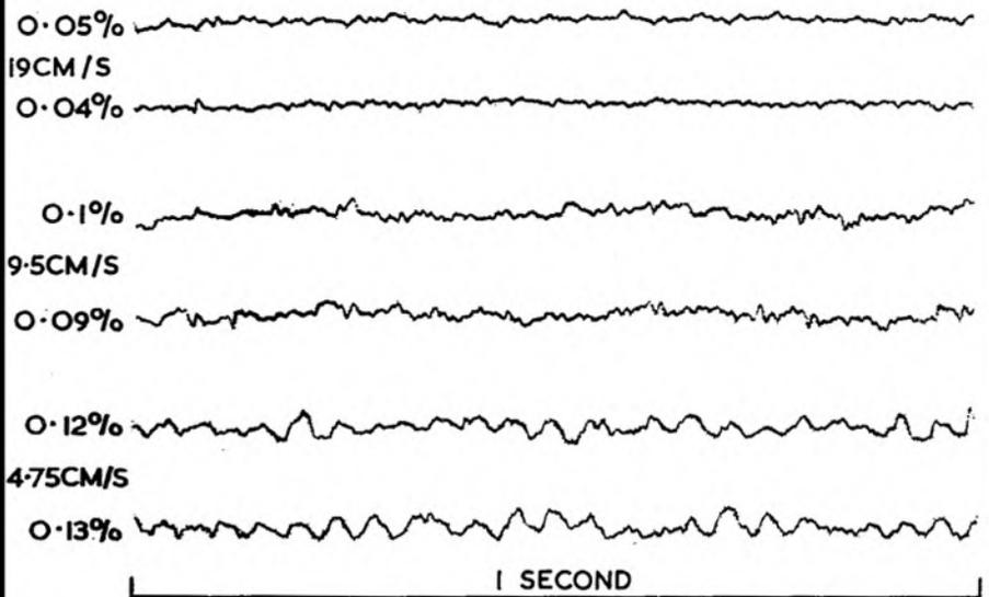
PLAY ONLY TESTS ON LOW WOW AND FLUTTER TEST TAPES
