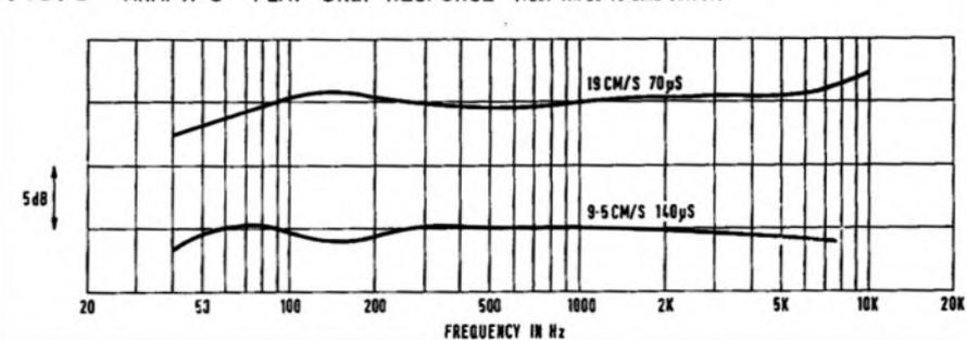
FIG. 4 AKAI X-5 RECORD/PLAY RESPONSE (LINE IN TO LINE OUTPUT)
