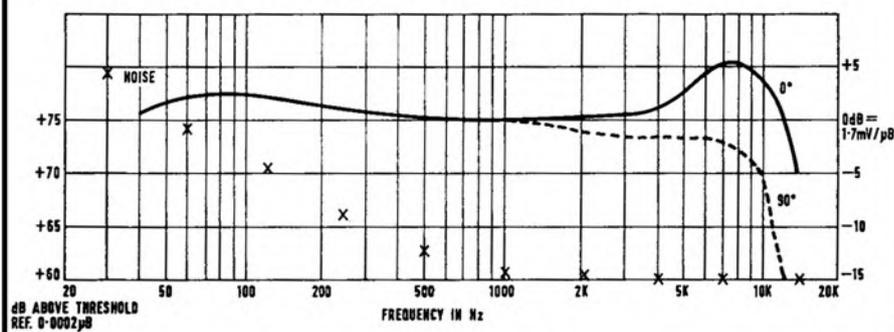
FIG. 2 FI-CORD FC650 CAPACITOR MICROPHONE (200 OHMS IMPEDANCE)
