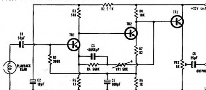
FIG. 2 RECORD AMPLIFIER (ONE CHANNEL)
