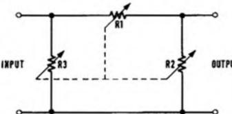
FIG. 7 THE LADDER ATTENUATOR
