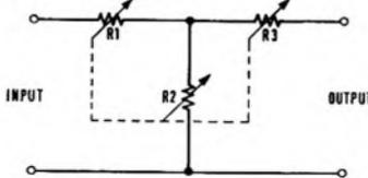
FIG. 6 THE  $\pi$ -ATTENUATOR
