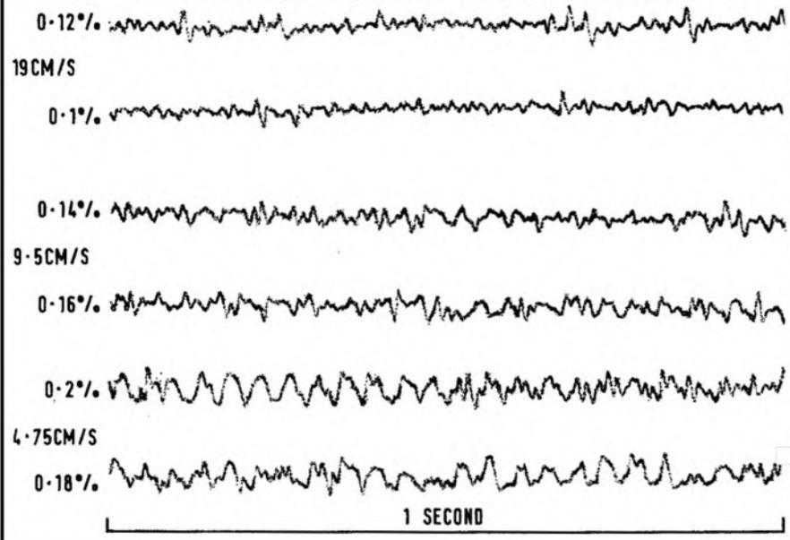
**FIG. 3** SONY TC355 PLAY-ONLY RESPONSE (TEST TAPE TO LINE OUT)
