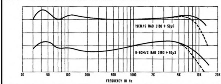
**FIG. 4** SONY TC355 RECORD/PLAY RESPONSE (LINE IN TO LINE OUT)
