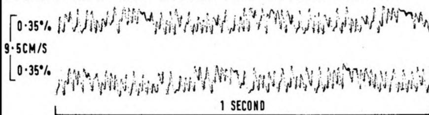
FIG. 2 PHILIPS 4307 PLAY-ONLY RESPONSE (NAB 90 + 3180µS TEST TAPE TO LINE OUT)
