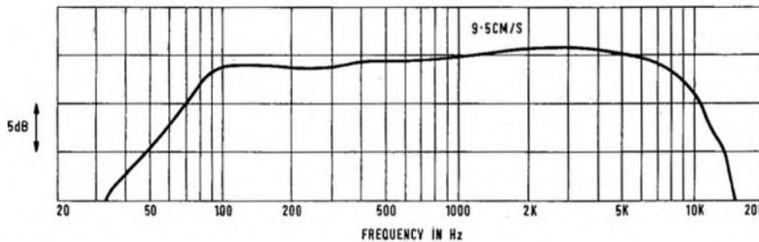
FIG. 3 PHILIPS 4307 RECORD-PLAY RESPONSE (LINE IN, BASF LGS 35, LINE OUT)
