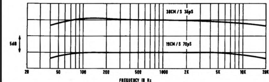
**FIG. 3 TELEFUNKEN M28C RECORD-PLAY FREQUENCY RESPONSE (LINE IN TO LINE OUT)**
