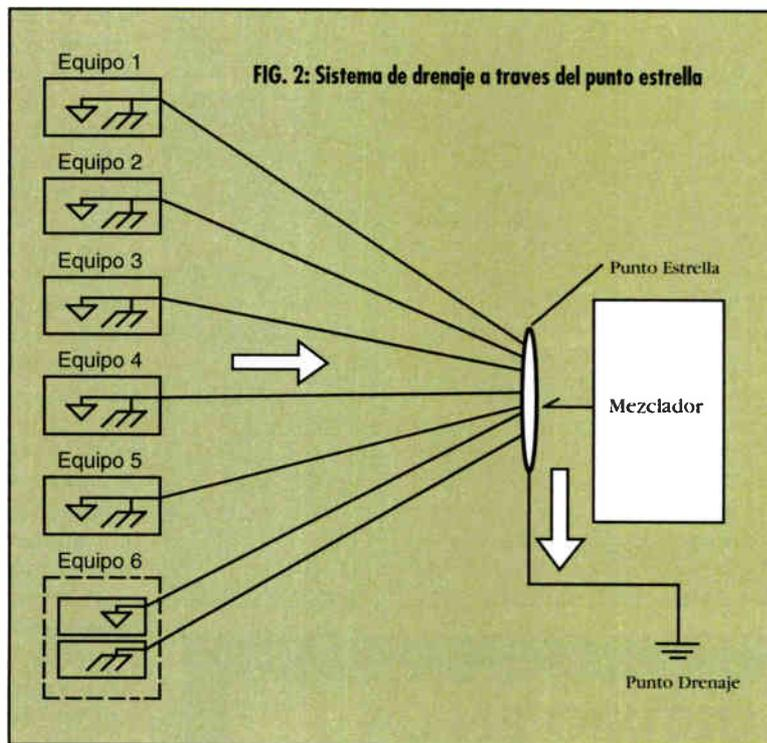
FIG. 2: Sistema de drenaje a través del punto estrella
