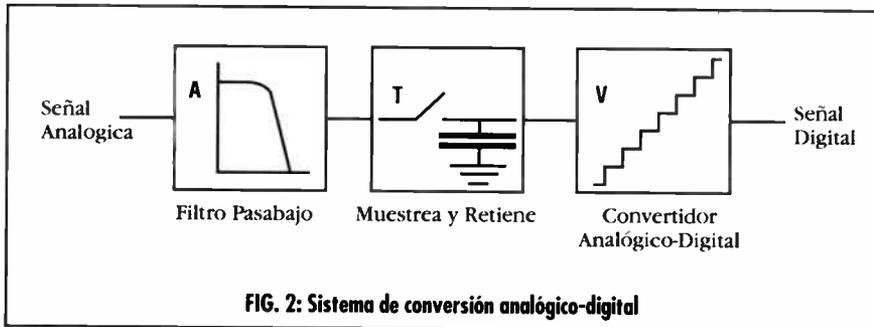
FIG. 2: Sistema de conversión analógico-digital
