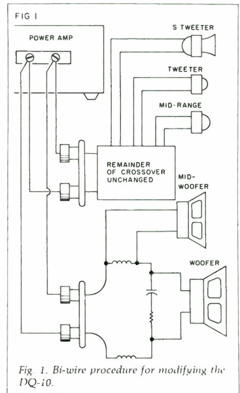
Fig. 1. Bi-wire procedure for modifying the DQ-10.
