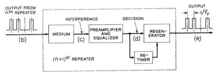
BLOCK SCHEMATIC OF PULSE TRANSMISSION LINK IN PCM
