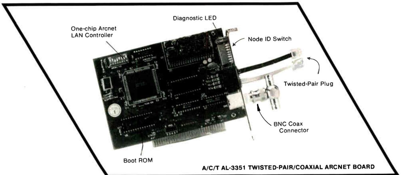
**A/C/T AL-3351 TWISTED-PAIR/COAXIAL ARCNET BOARD**
