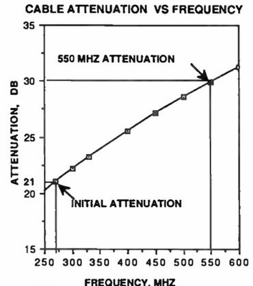
**FIGURE 7. OPERATIONAL GAIN REQUIRED WHEN UPGRADING FROM 270-550 MHz**
