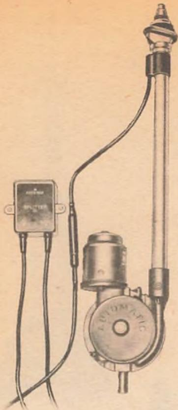
*Fig. 5-8. A Retractable Antenna.*
