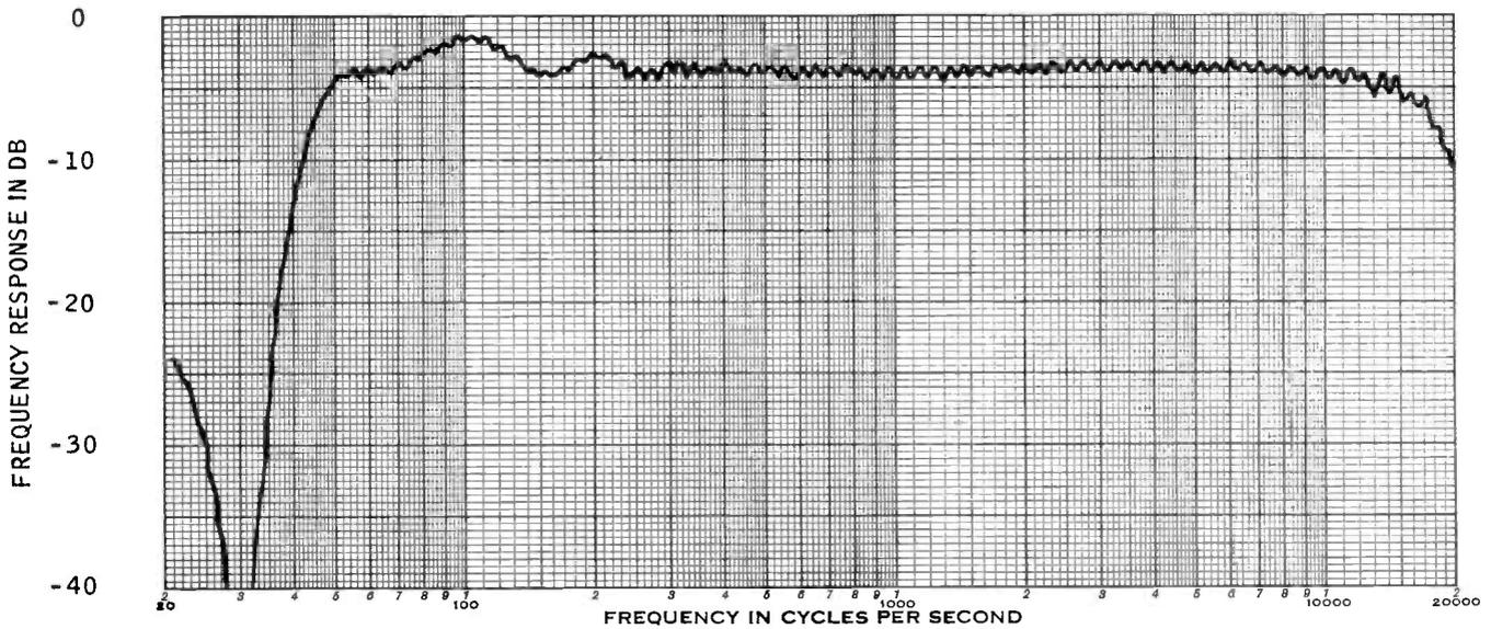
Fig. 14 FREQUENCY RESPONSE AT OPERATING LEVEL
