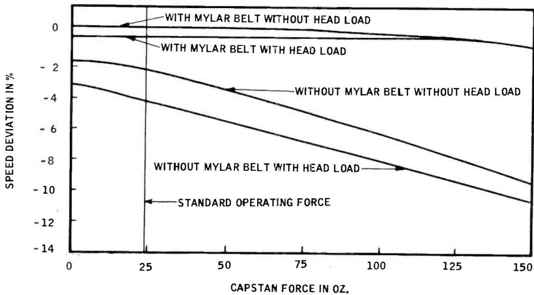
Fig. 7 TURNTABLE SPEED VARIATION VERSUSCAPSTAN FORCE
