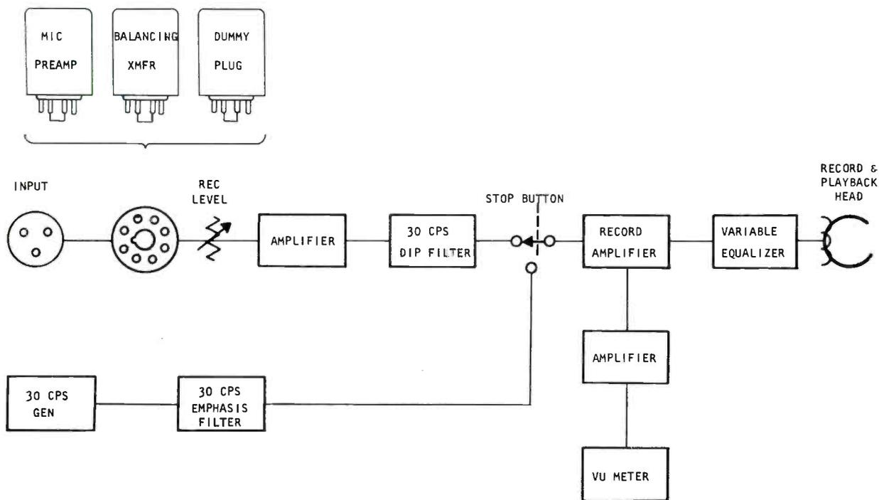
Fig. 8 RECORD CIRCUIT BLOCK DIAGRAM
