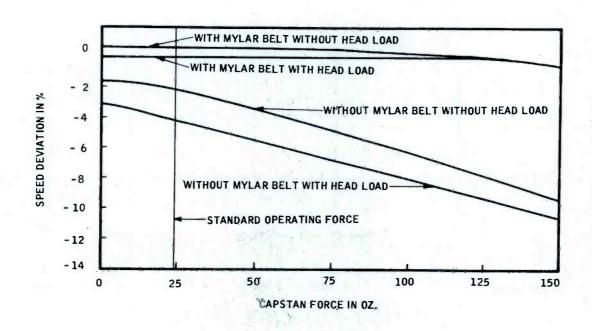
Fig. 7 TURNTABLE SPEED VARIATION VERSUS CAPSTAN FORCE
