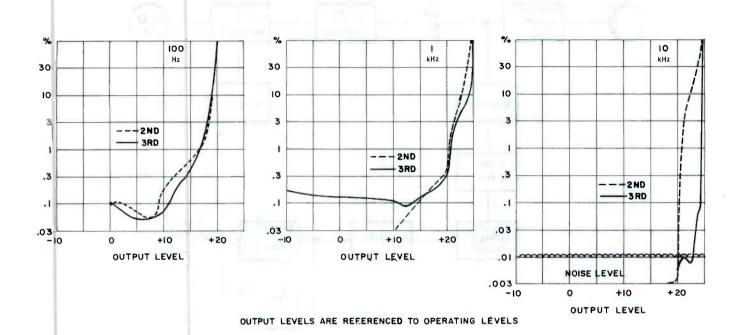
Fig. 13 AG-100 PLAYBACK AMPLIFIER DISTORTION
