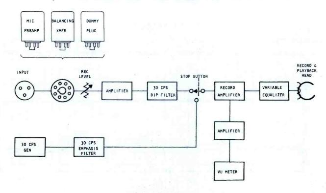
Fig. 8 RECORD CIRCUIT BLOCK DIAGRAM
