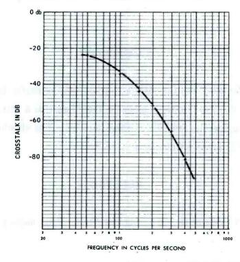
Fig. 2 TRACK-TO-TRACK CROSSTALK VERSUS FREQUENCY
