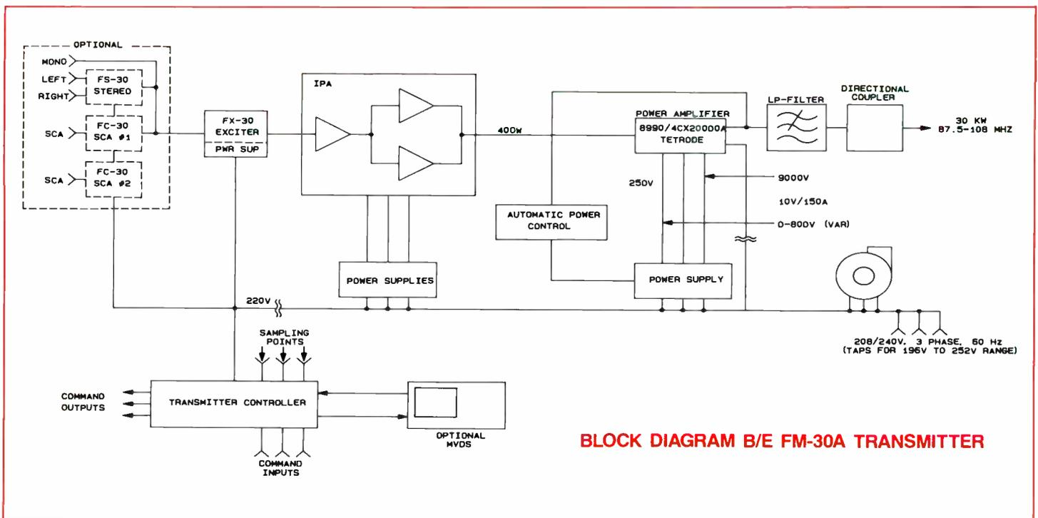
**BLOCK DIAGRAM B/E FM-30A TRANSMITTER**
