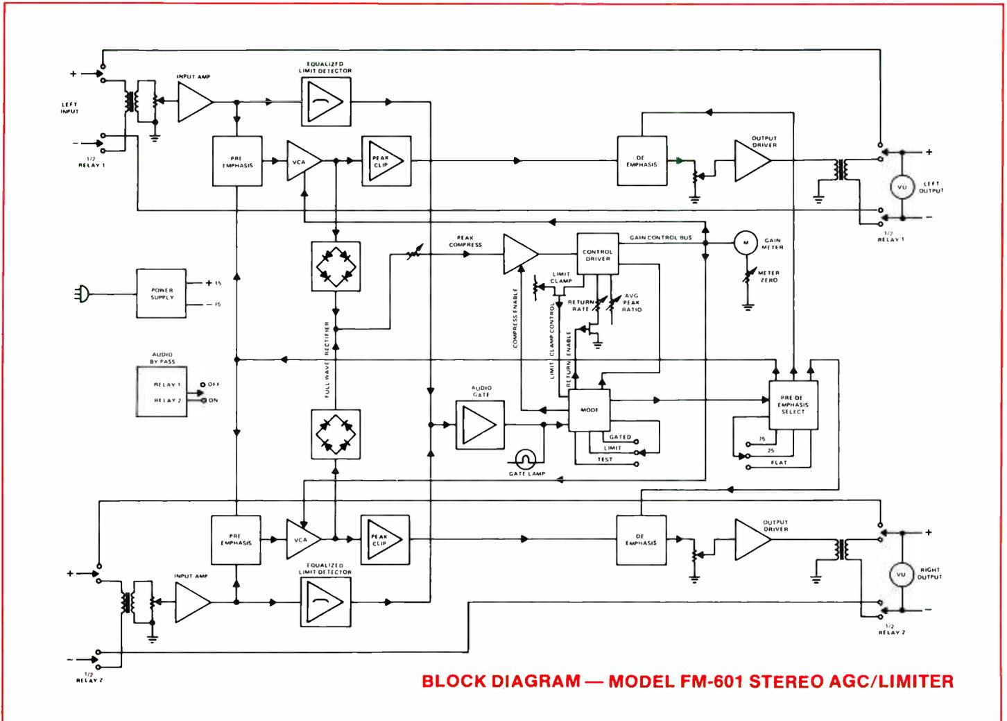
**BLOCK DIAGRAM — MODEL FM-601 STEREO AGC/LIMITER**
