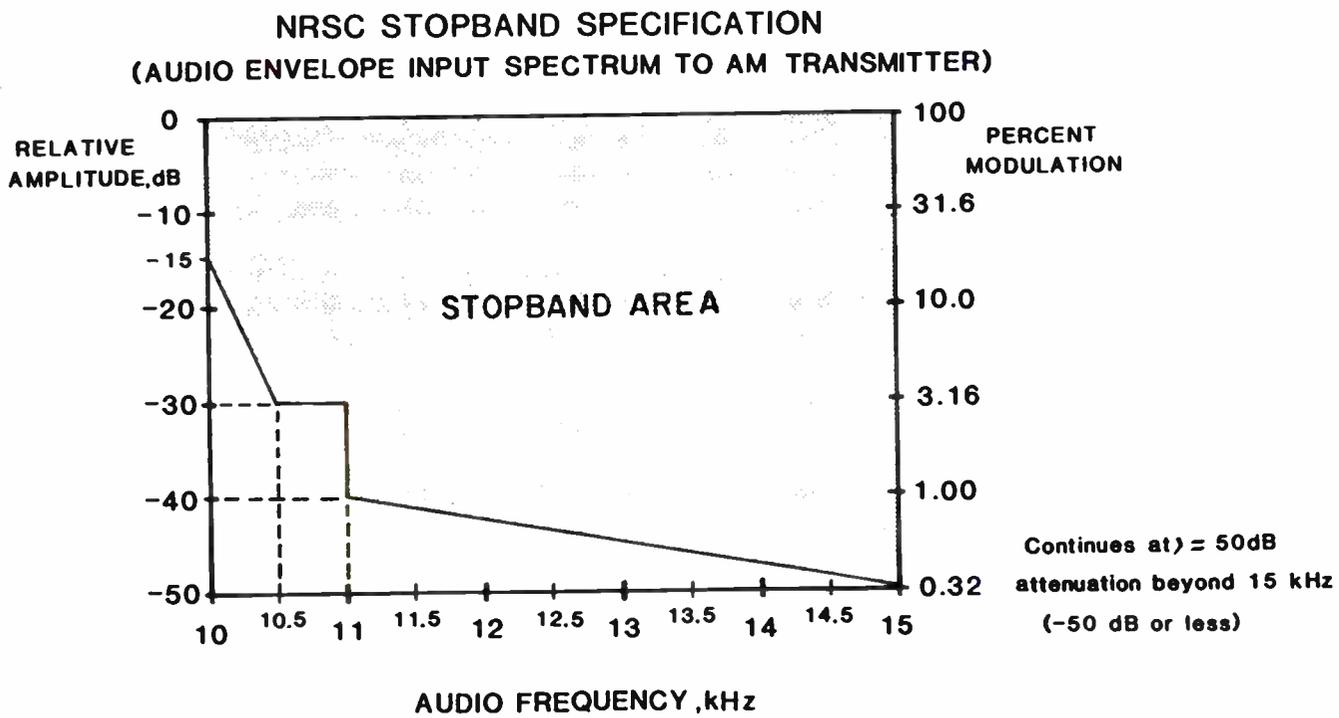
FIGURE 4-2 NRSC STOPBAND SPECIFICATION
