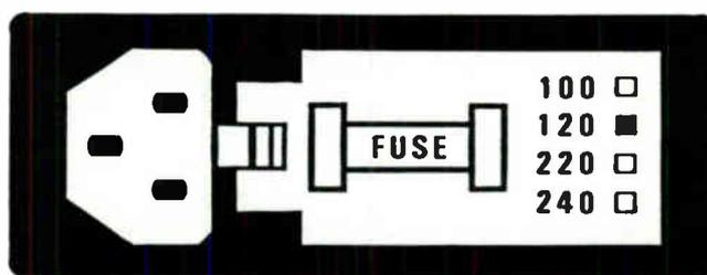
FIGURE 2-3 LINE VOLTAGE SELECTION
