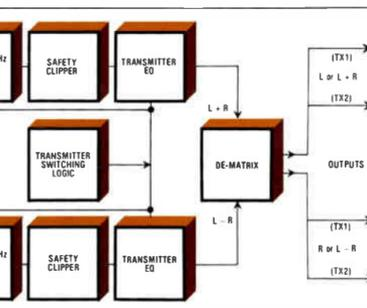
SYSTEM BLOCK DIAGRAM (STEREO CONFIGURATION)
