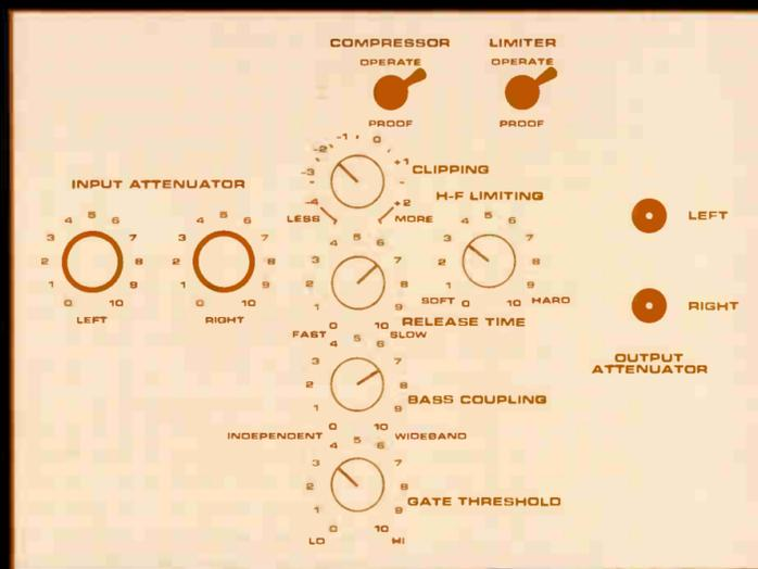
FIGURE 1: RECOMMENDED INITIAL CONTROL SETTINGS
