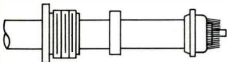
3. TAPER BRAID. SLIDE NUT AND GASKET OVER VINYL JACKET. PLACE CLAMP OVER BRAID AND PUSH BACK OVER CABLE JACKET. BE SURE INNER SHOULDER OF SLEEVE FITS SQUARELY AGAINST END OF CABLE JACKET.
