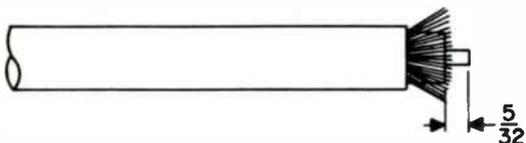
2. COMB OUT COPPER BRAID. CUT OFF CABLE DIELECTRIC 5/32 FROM END. TIN CENTER CONDUCTOR.
