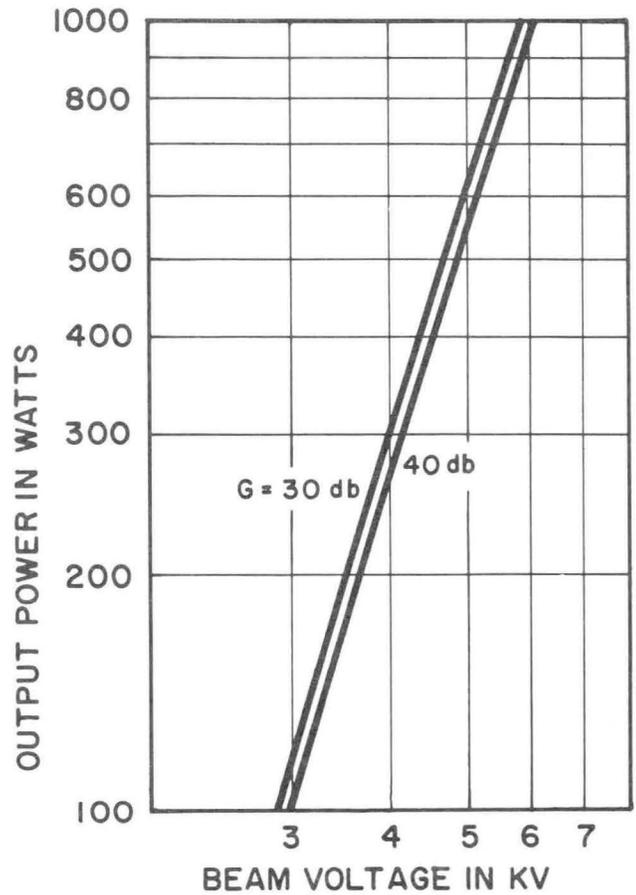
CAVITIES TUNED FOR MAXIMUM EFFICIENCY
