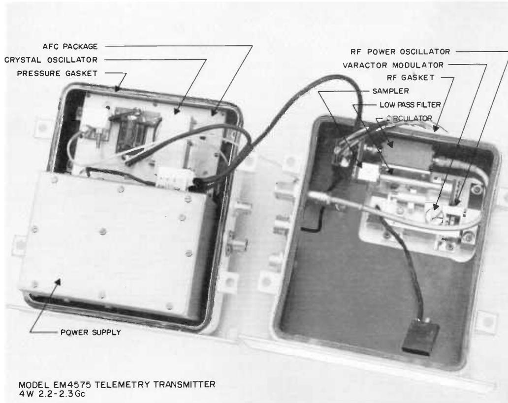
MODEL EM4575 TELEMETRY TRANSMITTER
