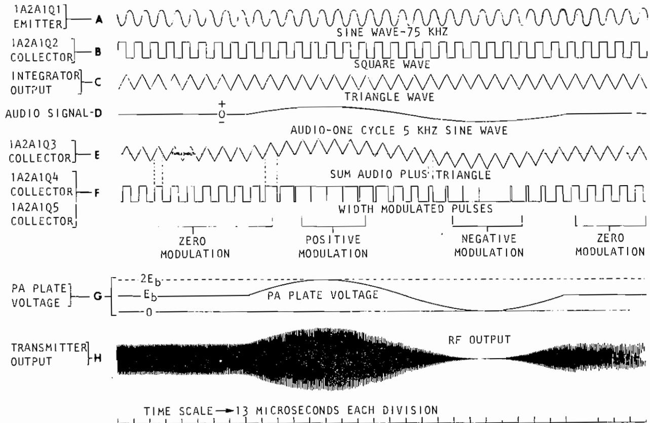
Figure 4-9. PDM Waveform
