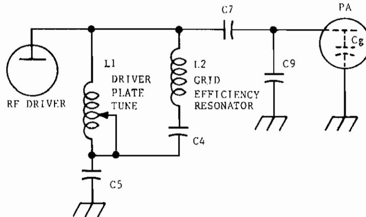
B. FUNDAMENTAL FREQUENCY EQUIVALENT CIRCUIT
