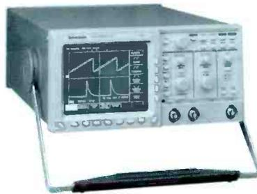
**TDS320 Digital Real Time Oscilloscope**
