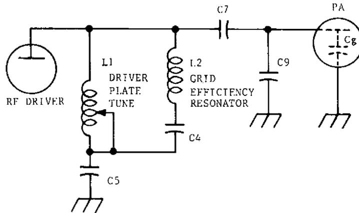
B. FUNDAMENTAL FREQUENCY EQUIVALENT CIRCUIT
