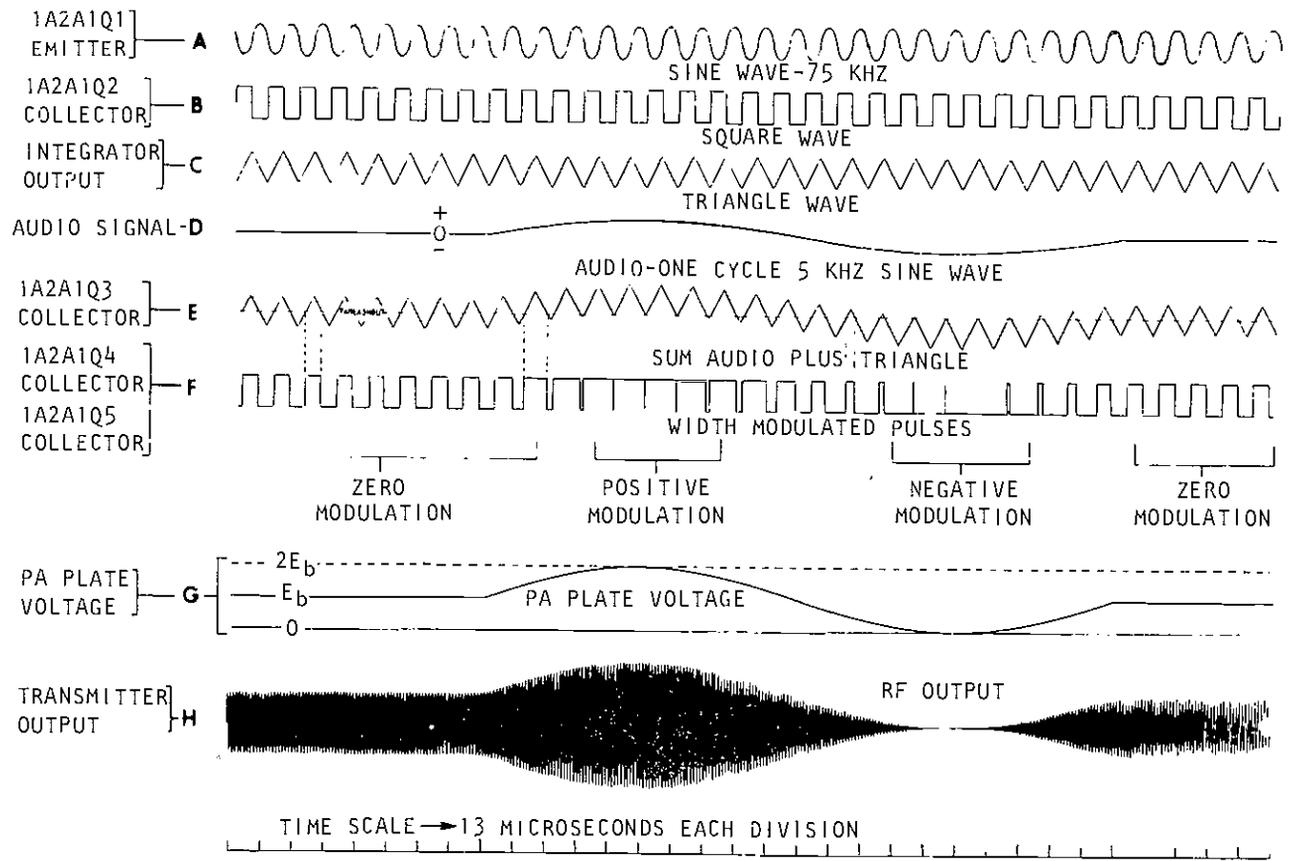
Figure 4-9. PDM Waveform
