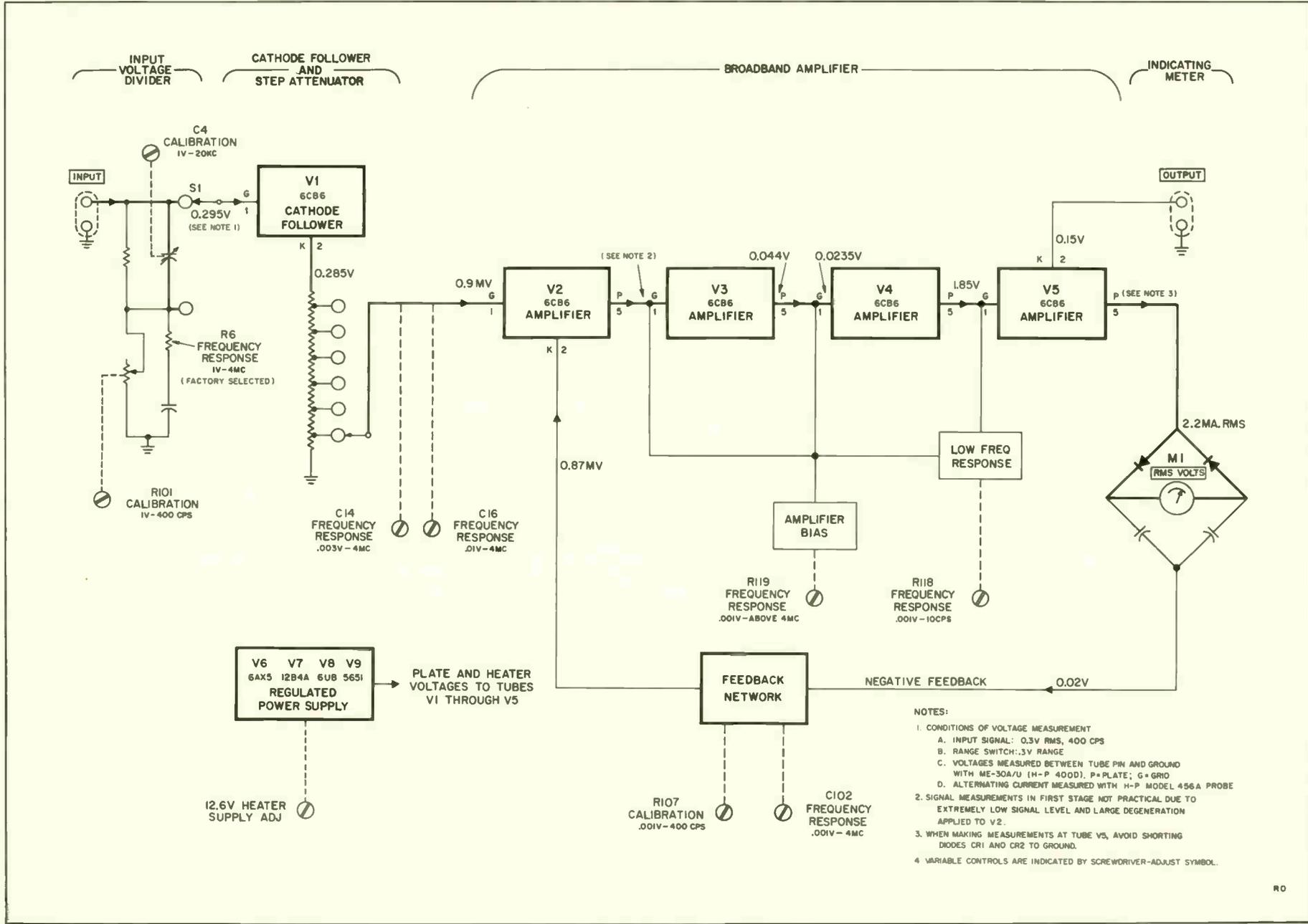
Figure 4-1. Voltmeter Block Diagram
