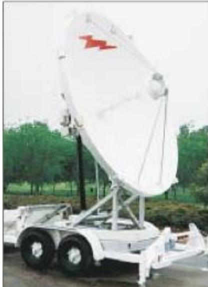
3.7-Meter Transportable Antenna
