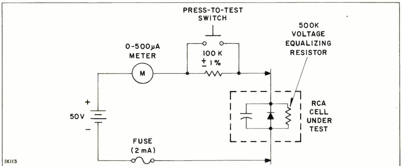
Figure 11. Rectifier Test Circuit
